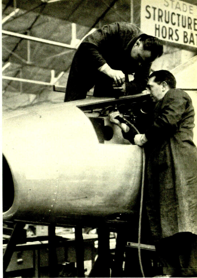
En av de industrigrenar, där Atlas Copcos tryckluftverktyg vunnit ökad användning, är flygplansindustrin. En nihammare av Atlas Copcos tillverkning ses här i arbete vid produktionen av det franska reaktivplanet Super Mystère.
