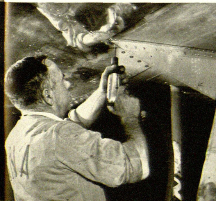
Injectors produktion omfattar huvudsakligen tryckluftverktyg. På bilden visas en hos detta bolag tillverkad skruvidragnare i arbete vid Australian National Airways i Melbourne.
