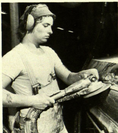
Ny slipmaskin med inbyggt dammsugger bättre sikt och hälsosammare miljö.
