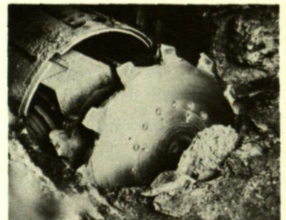
Mini Fulltacer, ett aggregat för drivning av små tunnlar utan sprängning, bevisade sin kapacitet på många håll i världen.
