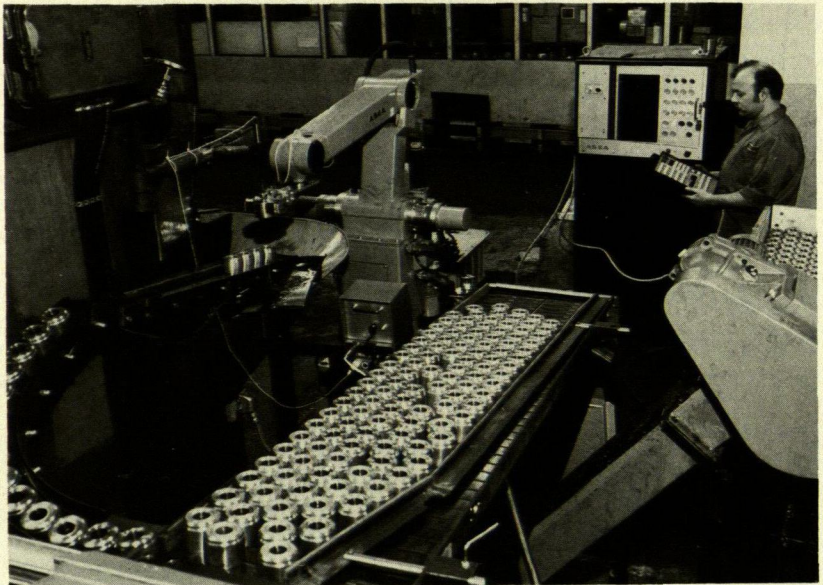
Vid Sicklaverken har en robot tagit över ett enformigt arbetsmoment vid tillverkning av bergbormaskiner.
