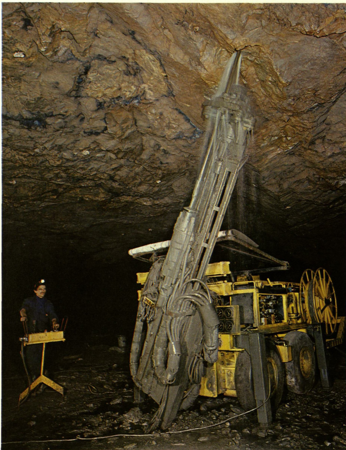
Atlas Copcos helhydrauliska underjordsrigg Simba H 221 utnyttjas hos Pirites Alentejanas, en av Portugals viktigaste gruvor. Riggen är utrustad med separat manöverbord för avståndsmanövrering, vilket ger en väsentligt förbättrad arbetsmiljö.
