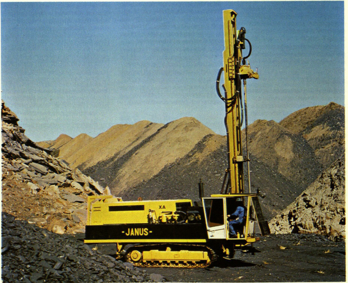
Ett nytt borraraggregat, specialkonstruerat för kolbrytning i dagbrott, är resultatet av ett samarbete mellan Gruppens bolag i Italien och Sydafrika. Aggregatet, som har dubbelt borrar-system – såväl slående som roterande – har uppkallats efter Janus, den grekiske guden med två ansikten.
