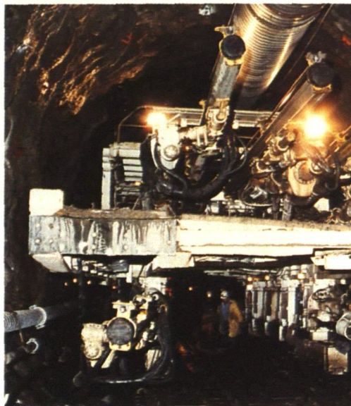
En jumborigg med fem bommar och hydrauliska bergbormaskiner har bl a borrarat den största tunneln för ett vattenkraftprojekt söder om Queens-town på Tasmanien.
